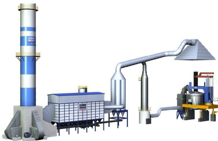
Figura 24 - Sistema secundário e visão geral do sistema de despoeiramento
